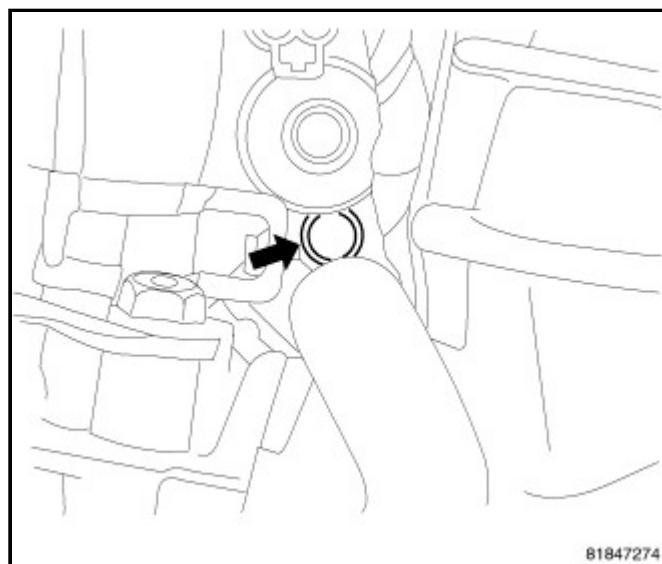
8. 直着将电磁阀拉出缸盖。
