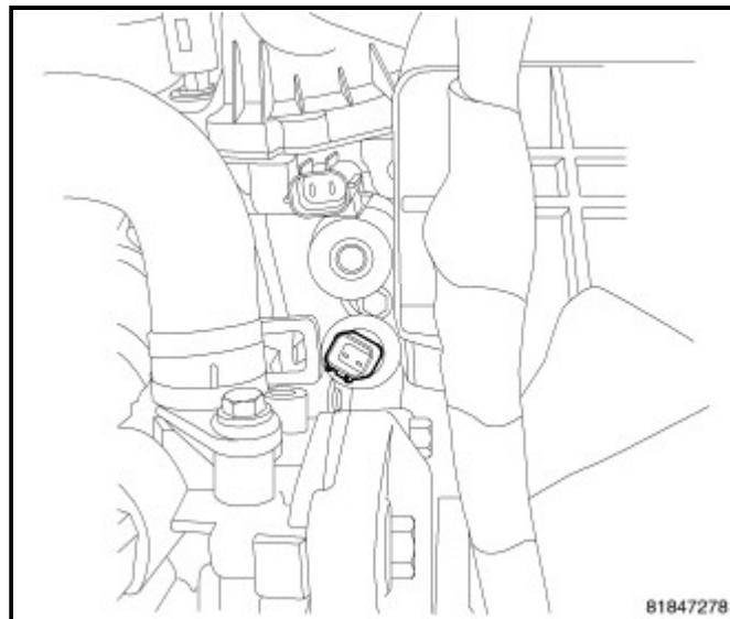
7. 拆下可变气门正时电磁阀固定螺栓。
